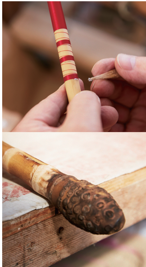
竹の根をすべて切り落とすと、丸い形が出てくる 頭の中に絵柄を思い浮かべながら、一定の間隔で細い糸を巻き 糸の上に漆を塗って固め、竿の柄を作っていく
