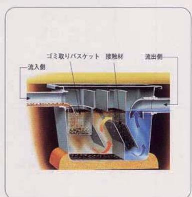
点検清掃の周期は、使用状況によって異なりますが、1週間に1回を目安として清掃してください。回収した油・ゴミを入れたポリ袋は、しっかりと封をして「燃えるゴミ」として指定のゴミ置き場に出してください。
